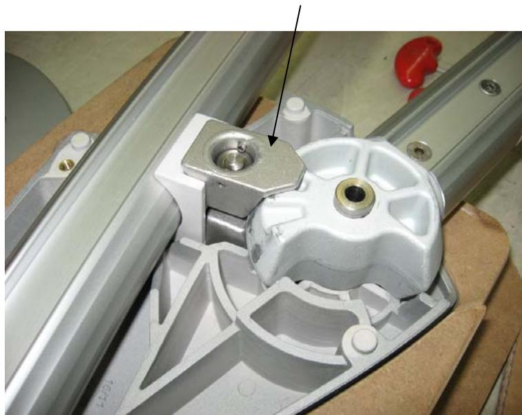
Zweite Hälfte der Tragarmführung aufsetzen und mit den vier Schrauben befestigen.
