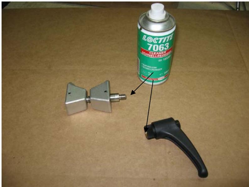
Klemmeinheit in die Tragarmführung einsetzen.
