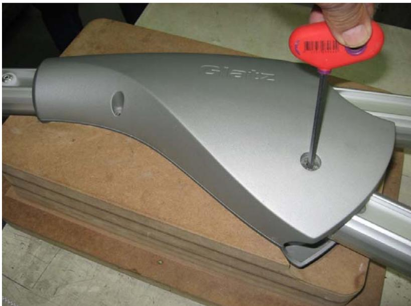
Die obere Hälfte der Tragarmführung abnehmen und die Klemmeinheit ausbauen.
