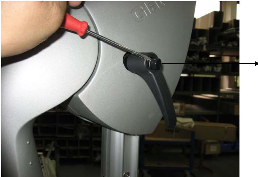
Bei der Tragarmführung die vier Schrauben entfernen.
